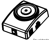
Drucktaster unten, Kabeldurchführung mit Tülle an der Seite. (Push-button underside, cable bushing with spout on the side.)
