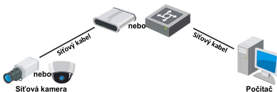
Obrázek 2–2 Připojení přes přepínač nebo směrovač
