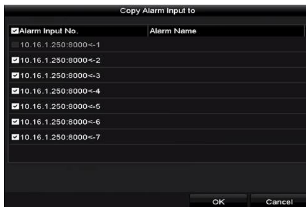
Obrázek 5–21 Kopírování vstupu alarmu
