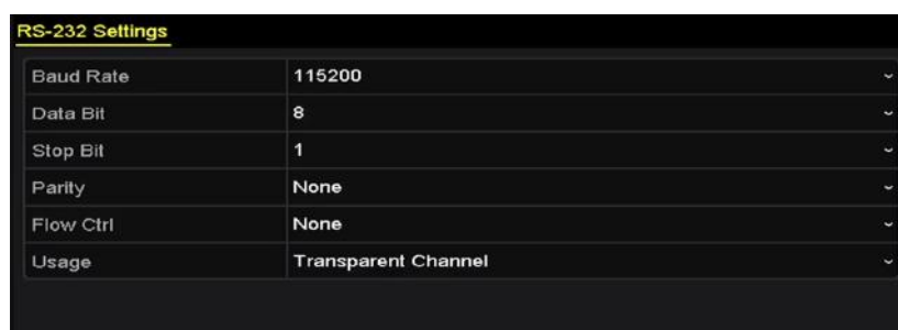
Obrázek 9–9 Nastavení rozhraní RS-232
