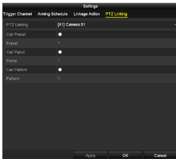
Obrázek 8–9 Nastavení propojení PTZ vstupu alarmu
