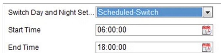
Obrázek 10-6 Přepínač plánování den/noc
