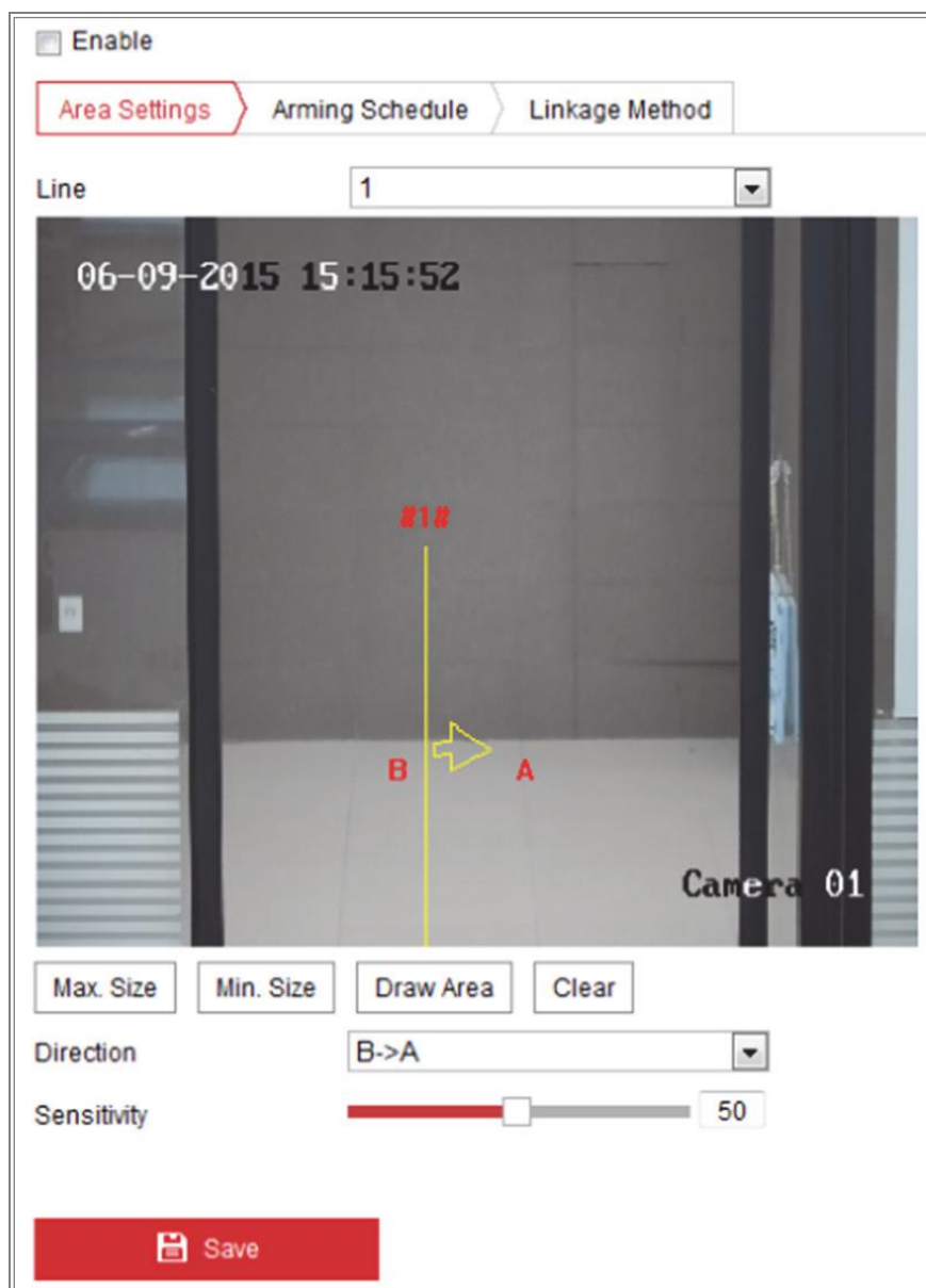
Obrázek 10-20 Detekce překročení linie
