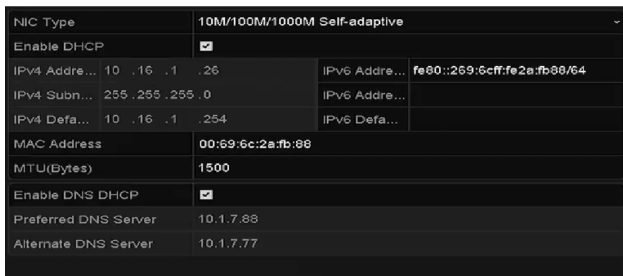
Obrázek 12–16 Okno nastavení sítě
